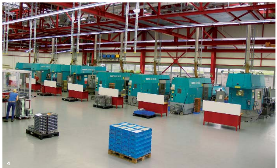
3 Gesteuert wird die MS22C-8 durch die Solution-Line-Steuerung von Siemens mit Touch-Bedienfeld von Index. 4 Die Index-Maschinen sind bei Gero in Gruppen angeordnet. Derzeit führt Gero mehrere Fertigungslinien ein, die die Maschinen, das Qualitätsmanagement und das Endverpacken der fertigen Werkstücke umfassen.
