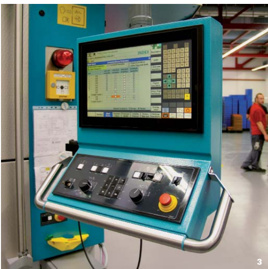
3 Gesteuert wird die MS22C-8 durch die Solution-Line-Steuerung von Siemens mit Touch-Bedienfeld von Index. 4 Die Index-Maschinen sind bei Gero in Gruppen angeordnet. Derzeit führt Gero mehrere Fertigungslinien ein, die die Maschinen, das Qualitätsmanagement und das Endverpacken der fertigen Werkstücke umfassen.
